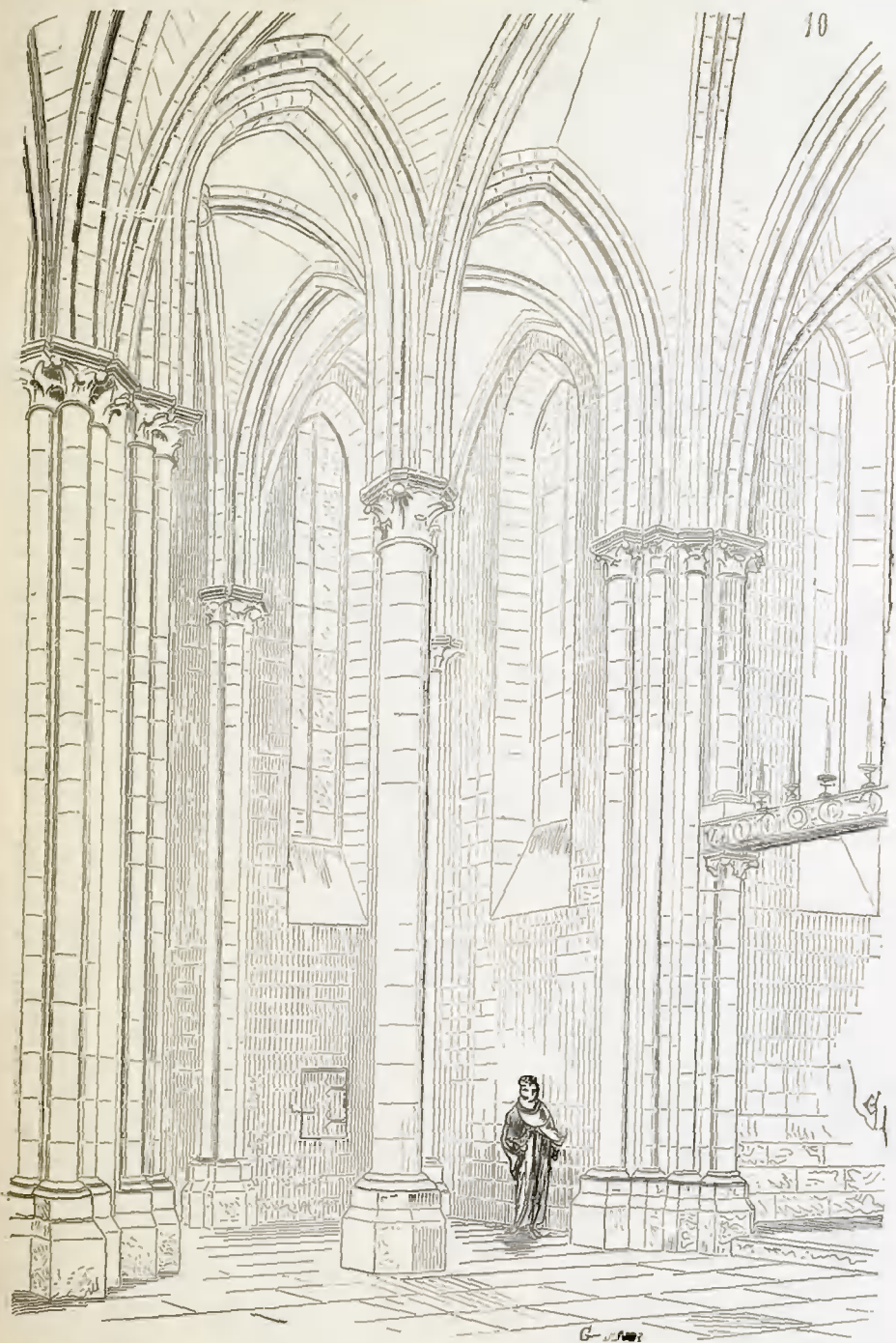
Dame de Dijon (fig. 11). Ici la galerie du triforium s'interrompt pour laisser la place de la rose, simplement garnie d'une armature de fer 1 ,
